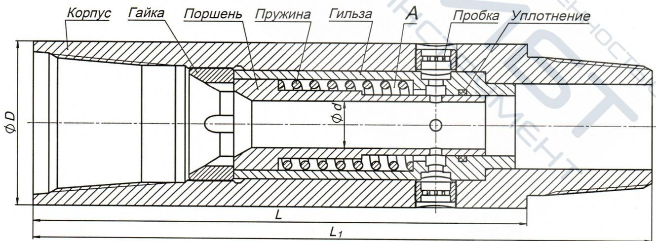
**Рисунок 4.1 - Принципиальная схема клапана переливного**
